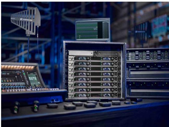
Transmitter disinkronkan dengan mudah melalui BLE dari jarak hingga 20 meter – operator tidak perlu berjongkok di depan rak untuk menghubungkan receiver dan transmitter. Parameter yang akan disinkronkan dapat ditentukan melalui menu receiver. Receiver EW-DX juga memberi Anda opsi untuk melakukan walk test guna memeriksa kualitas sinyal di seluruh panggung atau area pertunjukan.
