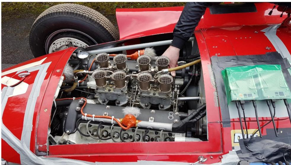
**DI SEBELAH KANAN, DUA RECEIVER SENNHEISER EK 6042 YANG DIPASANG PADA LANCIA-FERRARI D50A, MENERIMA AUDIO DARI MIKROFON BERDIAFRAGMA BESAR YANG DIUBAH MENJADI NIRKABEL OLEH SKP PLUG-ON TRANSMITTER.**
