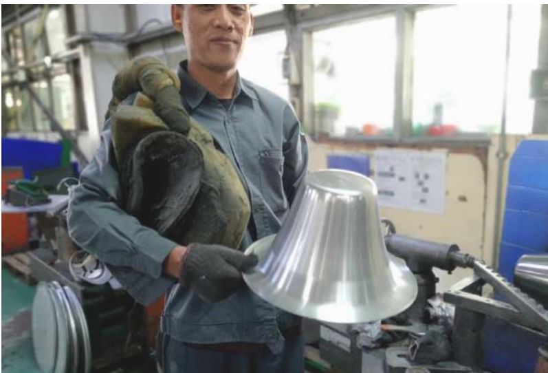
HASILNYA PAKAI TANGAN LEBIH RAPIH ( TIDAK PECAH) DARI PADA MESIN
