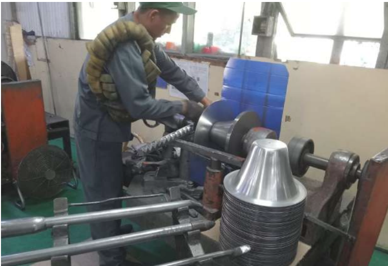
PROSES PEMBUATAN CORONG TOA MIRIP BIKIN VAS KERAMIK PAKAI TANGAN
